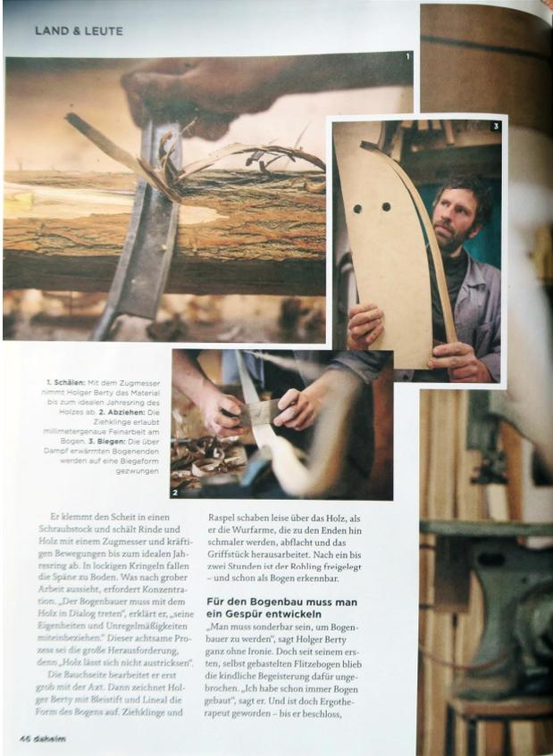
**1. Schälen:** Mit dem Zugmesser nimmt Holger Bertly das Material bis zum idealen Jahresring des Holzes ab. **2. Abziehen:** Die Ziehklinge erlaubt millimetergenaue Feinarbeit am Bogen. **3. Biegen:** Die über Dampf erwärmten Bogenenden werden auf eine Biegelform gezwungen
